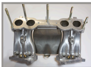
КОЛЛЕКТОР С УСТАНОВЛЕННЫМИ РАСПЫЛИТЕЛЯМИ
