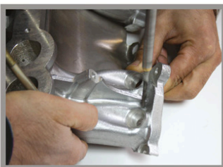
РАЗМЕТКА ОТВЕРСТИЙ ПЕРЕД УСТАНОВКОЙ РАСПЫЛИТЕЛЕЙ
