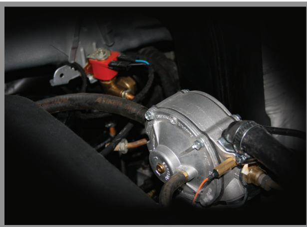
Regülatörün araca yerleşimi Mounting the reducer to the vehicle.
