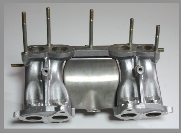
Manifold araçtan sökülerek delme işlemine hazırlanır. The manifold is prepared drill process by demount.
