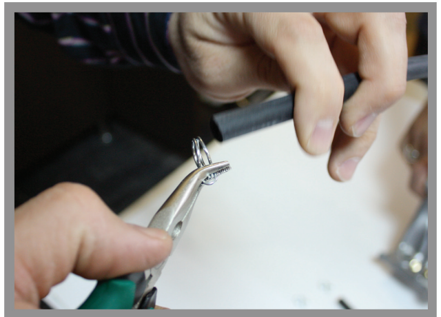
Manifoldta hortumlarına kelepçelerin takılması Mounting the clips to the hoses of manifold.
