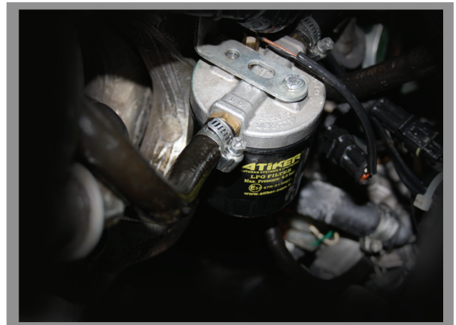
Filtrenin araca yerleşimi The lay-out of the filter to the vehicle
