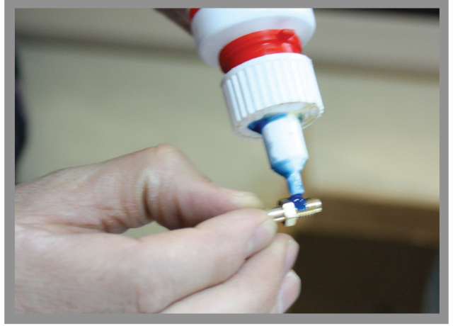
Nozzle'ların ilaçlanması ve sızdırmazlığının sağlanması Glueing of the nozzles and providing impermeability.
